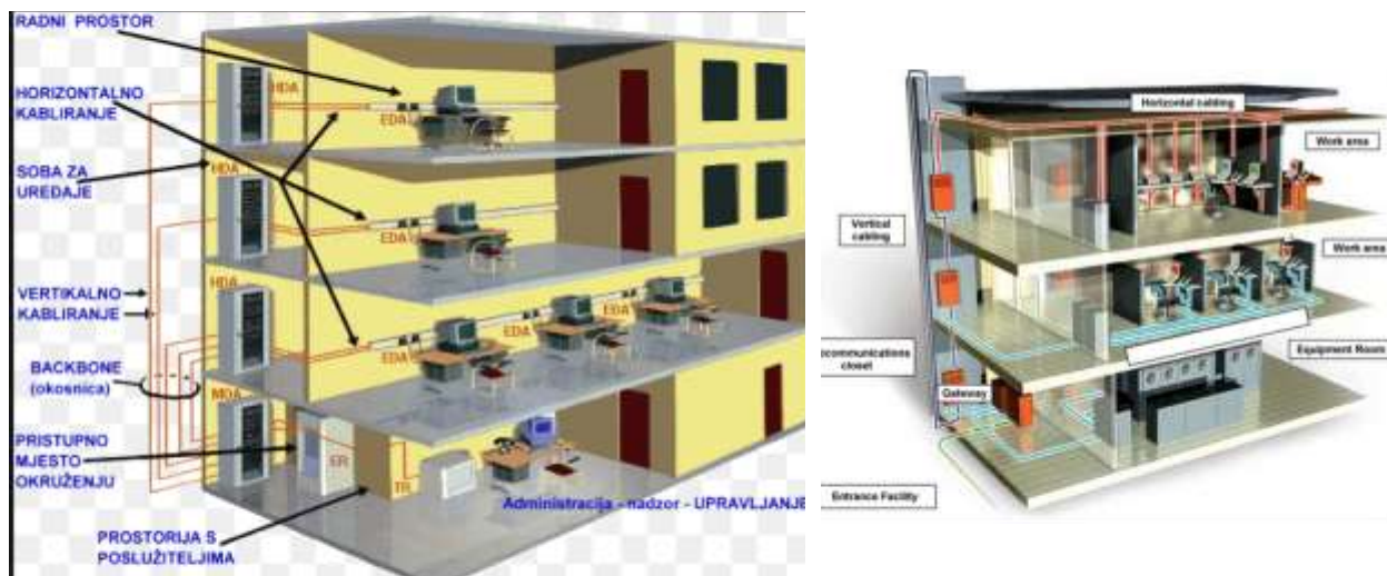
Implementacija strukturnog LAN kabliranja na primjeru jedne zgrade
