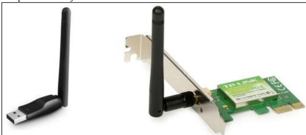
Lijevo WiFi adapter u obliku USB-a:, desno primjer PCI/PCIe bežičnog adaptera
