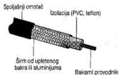
Slojevi koaksijalnog kablova
